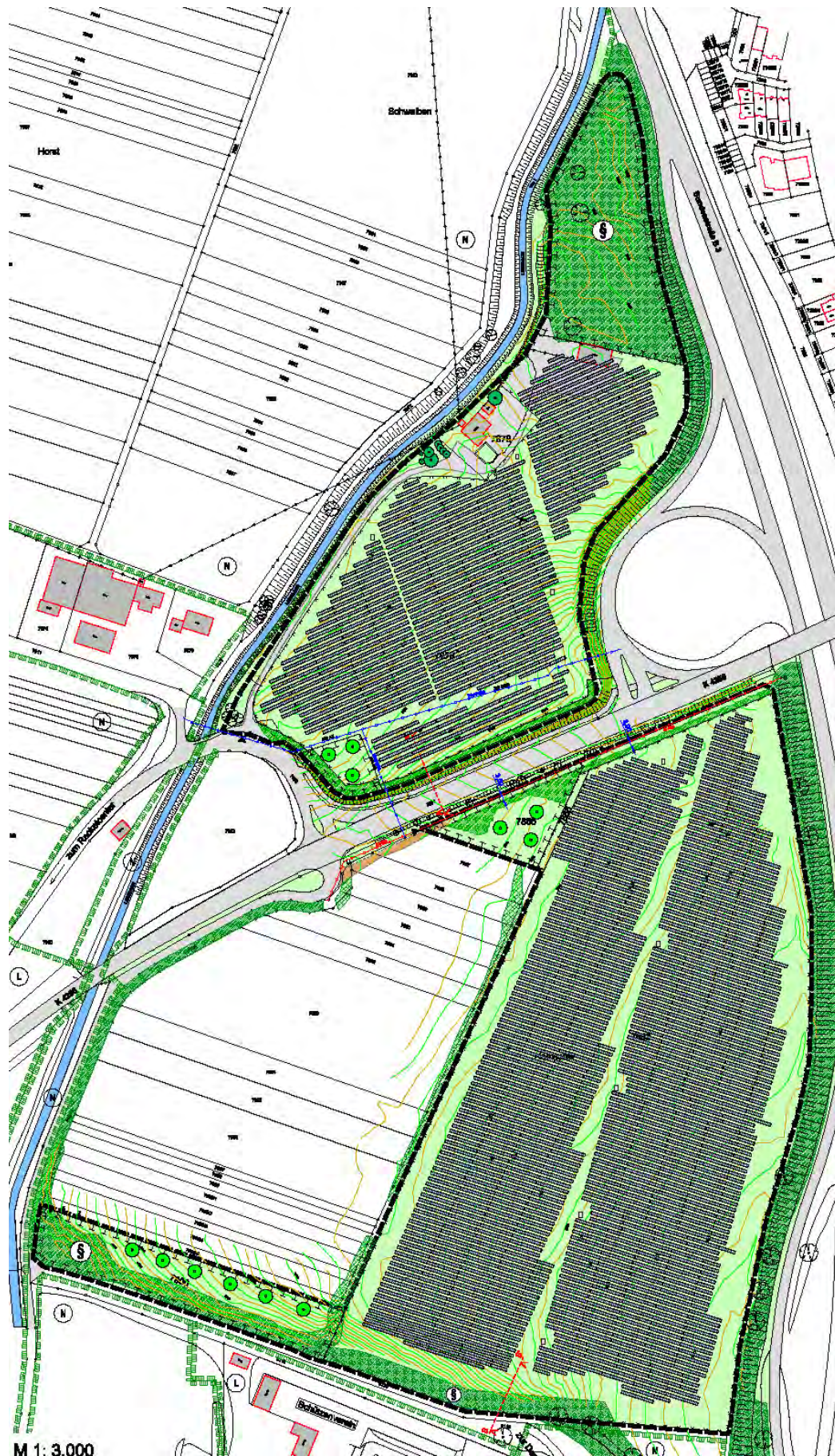
Abbildung 11: Geplanter Solarpark mit Anordnung der Module und Eingrünung
